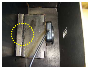
圖 4-15 縮短照度計與光柵的距離
